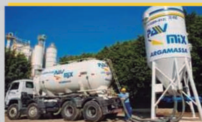
ABASTECIMENTO "IN LOCO" DOS SILOS
