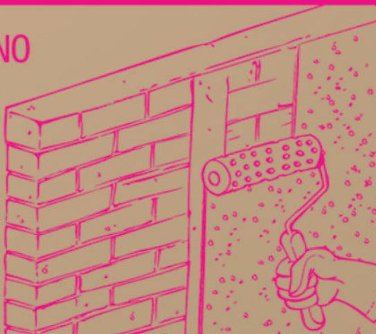
**A argamassa PAVMIX CHAPISCO ROLADO é adequada para a aplicação sobre superfícies de concreto e blocos de concreto, cerâmicos, sílico-calcários ou de concreto celular, bem como tetos de lajes pré-moldadas de blocos de concreto, cerâmicos ou de poliestireno expandido (isopor). A PAVMIX CHAPISCO ROLADO tem como função formar uma ponte de aderência para as argamassas de revestimento.**
