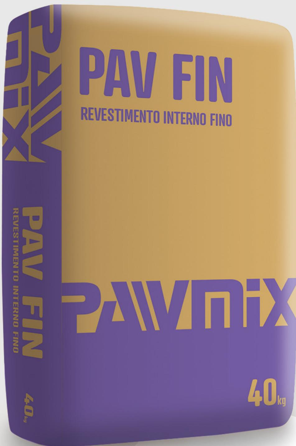
**A argamassa PAV FIN REVESTIMENTO INTERNO FINO é um micro revestimento, para áreas internas, adequado para alvenaria estrutural de blocos de concreto ou cerâmicos. Em todas as áreas internas de blocos de concreto e cerâmicos, não é necessária a aplicação de chapisco. Bases de concreto armado como lajes, piraes e vigas devem ser chapiscadas. Para este tipo de aplicação, recomendamos usar a PAVMIX CHAPISCO ROLADO.**
