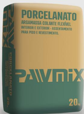
**A Argamassa Colante PAVMIX PORCELANATO é ideal para assentamentos de pisos cerâmicos, porcelanatos convencionais e grandes formatos. Pode ser aplicado em ambientes internos e externos, paredes e pisos. Composição: mistura homogênea de cimento Portland, agregados minerais naturais com granulometria controlada de natureza quartzosa, aditivos químicos não tóxicos.**
